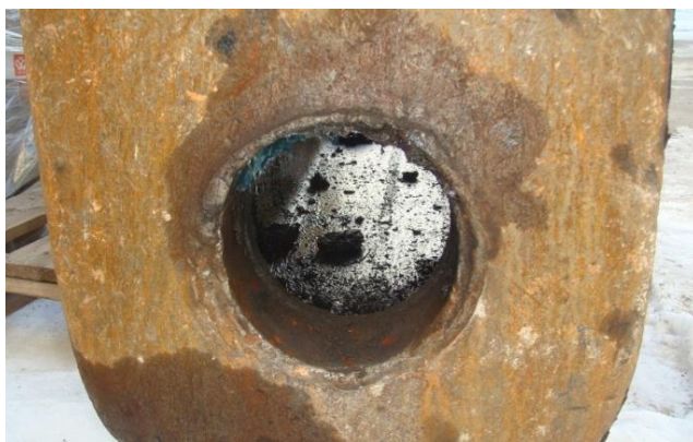
Корпус гидромолота до ремонта
