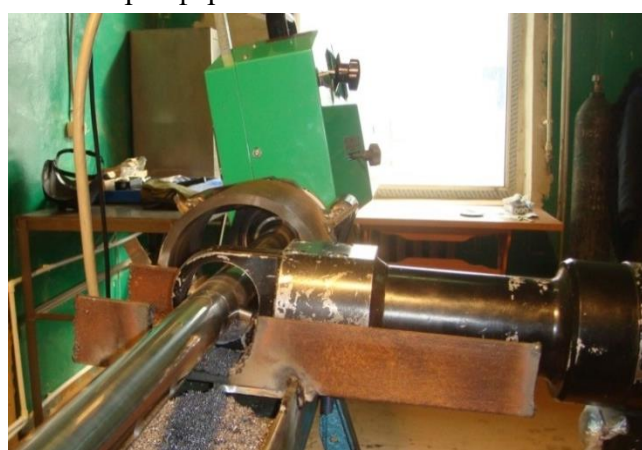
Ремонт проушины гидроцилиндра
