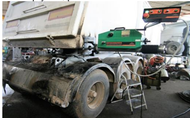
Ремонт подъемного механизма самосвала
